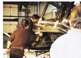
FMVSS216 連邦安全基準 車両重量の1.5倍の力でルーフを押しつぶします
